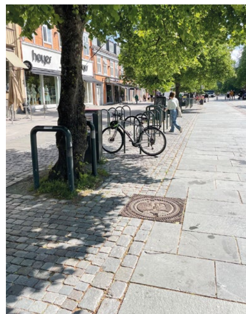
Smågatesteinen i møbleringssonen har en annen overflate enn skifer i gangsonen. Dette skaper naturlige ledelinjer og gir struktur og ryddighet til Trondheim by.
