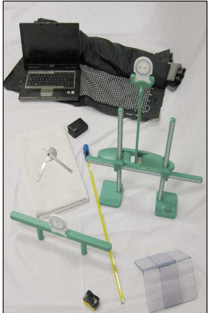
Noen av måleverktøyene som ble benyttet i prosjektet: Goldsmith's Anatomical Measuring Instrument (AMI), vinkel-mål, trykkmatten Xsensor Pressure Mapping System (XPMS-X3), fingerpulsoksimeter og målebånd.
